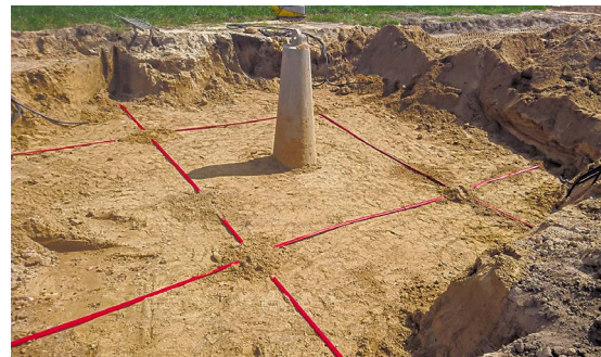
Messung einer vertikalen Bodenverschiebung – F&E-Bereich
